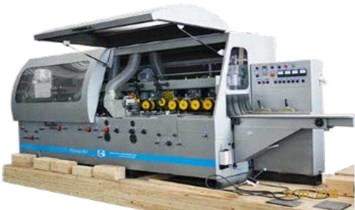
Станок серии С25-6АБ предназначен для производства различных погонажных изделий и профилированного бруса, в том числе естественной влажности.
